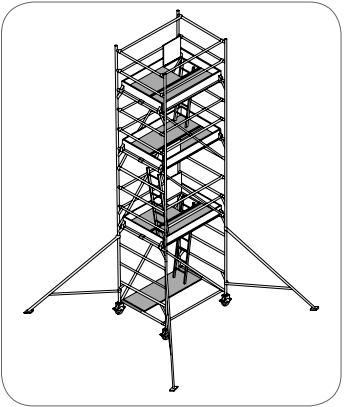
图 10: 配有梯级、入口和其它功能的流动鹰架以提供一个无隐患的工作平台。
